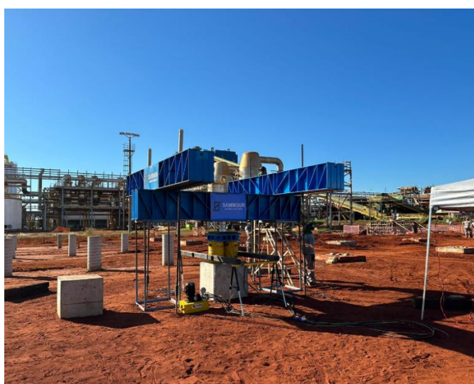
Figuras 1 e 2: montagem típica - ensaio PCE - Sammour Engenharia
