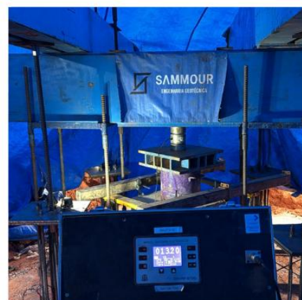
16 ensaios de prova de carga estática (PCE) em estação de tratamento de água. Valparaíso de Goiás - Goiás.
